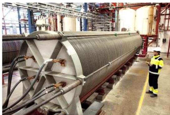
Existen numerosos diseños industriales que permiten llevar a cabo esta reacción de manera económicamente rentable. El método más empleado es la “Electrólisis del Agua Alcalina” (AEC, por sus siglas en inglés), que utiliza como electrolito una solución acuosa de hidróxido de potasio. En la fotografía se muestra un reactor típico utilizado para este proceso.
